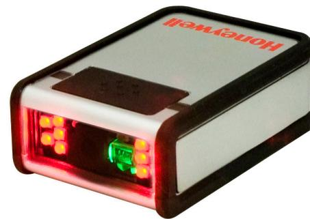
Компактный размер, эргономичная кнопка для большого пальца и яркий светодиодный индикатор обеспечивают удобство пользования фотосканером в ручном и наручном варианте. В сканере 3310g также предусмотрено универсальное крепление и реализован надежный режим стационарного сканирования, что позволяет применять его в качестве неподвижно закрепленного сканирующего устройства в промышленности (при нормальных условиях эксплуатации) и терминалах самообслуживания.
